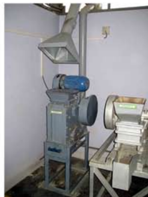
Foto 1: Se necesita limpiar la grasa de los cojinetes de la chancadora con más frecuencia. Las quijadas están muy separadas y se produce material grueso antes del cuarteo.
