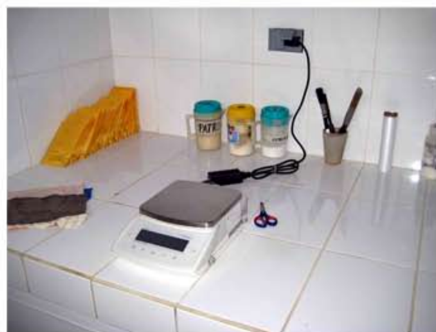
Foto 5: La balanza de ensayo al fuego nunca ha sido calibrada o certificada. El laboratorio no tiene un grupo de pesos estándares certificados.
